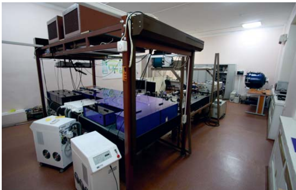
Фемтосекундная тераваттная «хром-форстерит» лазерная система ИК диапазона спектра
