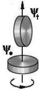
Рисунок 7. Устойчивые вращения диска с угловыми скоростями \psi_* и \psi_{\dagger} : нормальное (внизу) и нейтральное (наверху).
