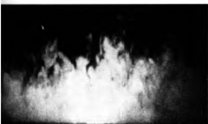
163. Косые поперечные сечения турбулентного пограничного слоя. Течение рассматривается спереди и визуализируется дымом, освещаемым световым ножом, который имеет наклон 45^\circ вниз по потоку от стенки (левые снимки) и 45^\circ вверх по потоку
